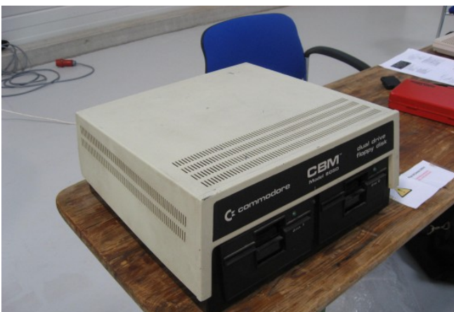
CBM 8050 Doppelfloppy. Groß, schwer, funktionsfähig und wie man im rechten Bild erkennen kann, äußerst Wartungsfreundlich. Mit zwei Schrauben zu öffnen und wie die PETs aufzuklappen.
